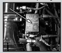
**Ballast Power-Port Side Engine Wall**
